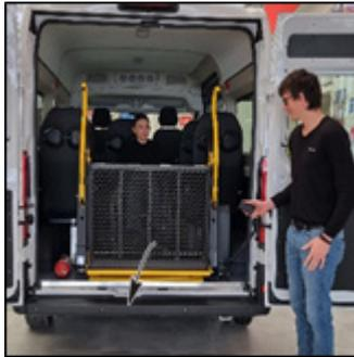
Rimanere a distanza e premere il pulsante di DISPIEGAMENTO fino all'arresto della piattaforma (al raggiungimento del livello del pianale - dispiegamento totale). Rilasciare il pulsante.
