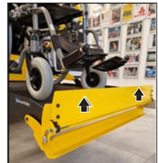
Avviso: il passeggero deve essere posizionato completamente all'interno delle delimitazioni gialle, e la barra di arresto deve essere in posizione verticale.
