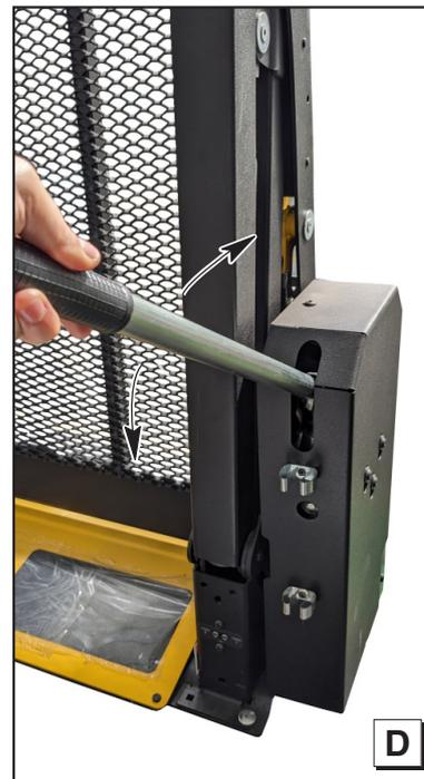
Avviso: il ponte e la barra di arresto funzionano automaticamente durante le manovre manuali.
