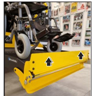
Avis : Le passager doit être positionné complètement à l'intérieur des limites jaunes et la butée escamotable doit être en position MONTER.
