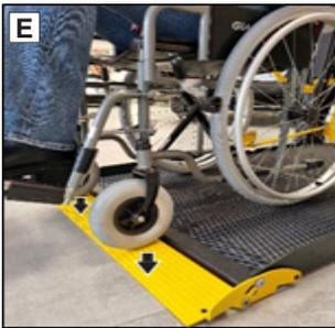
◀ Avis : La butée doit être complètement dépliée (position de la rampe) jusqu'à ce que l'ensemble du fauteuil roulant (ou de la personne debout) ait franchi la butée. Voir les photos E et F. ▶
