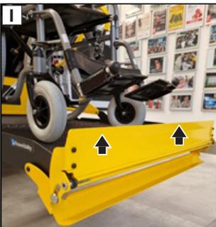
2. Pulse el botón ↑ ARRIBA (Foto H) para plegar el tope hacia ARRIBA completamente (en vertical; véase la Foto I) y eleve la plataforma hasta el nivel del suelo del vehículo. Véase la Foto J. Suelte el interruptor.
