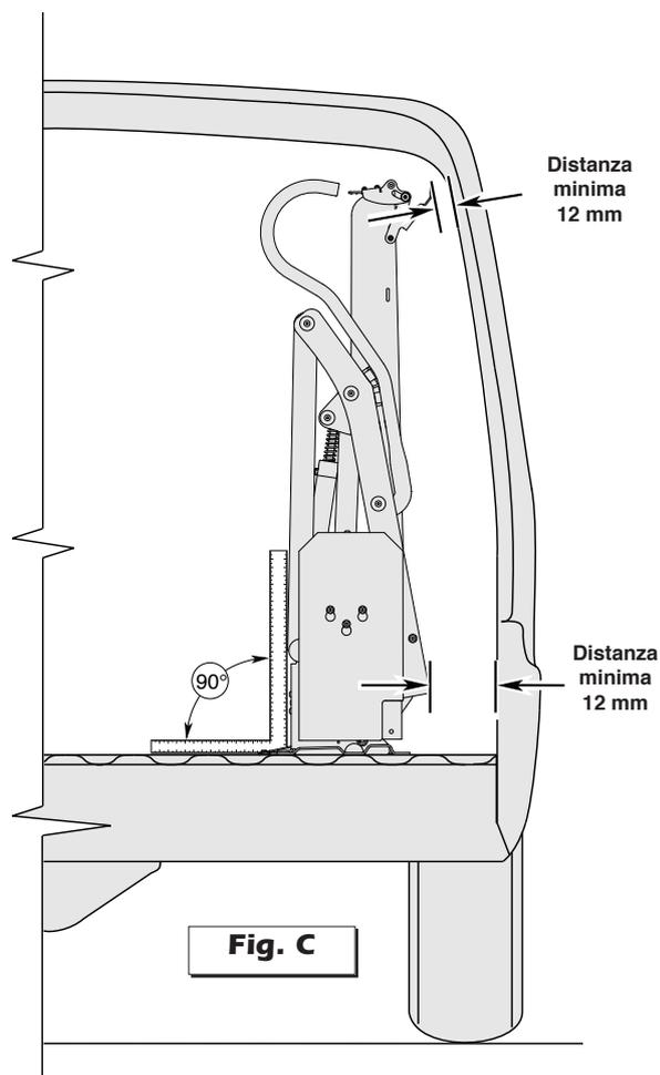
**Ganci Lift-Tite®:** quando si controlla la distanza dalla parete del veicolo, lasciare che la piattaforma si inserisca completamente nei ganci Lift-Tite® per assicurare il necessario spazio libero.
