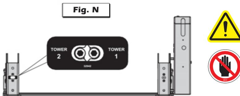
In figura, piattaforma con pompa a sinistra. Per le piattaforme con pompa a destra, i microinterruttori su torretta si trovano sul lato opposto.
