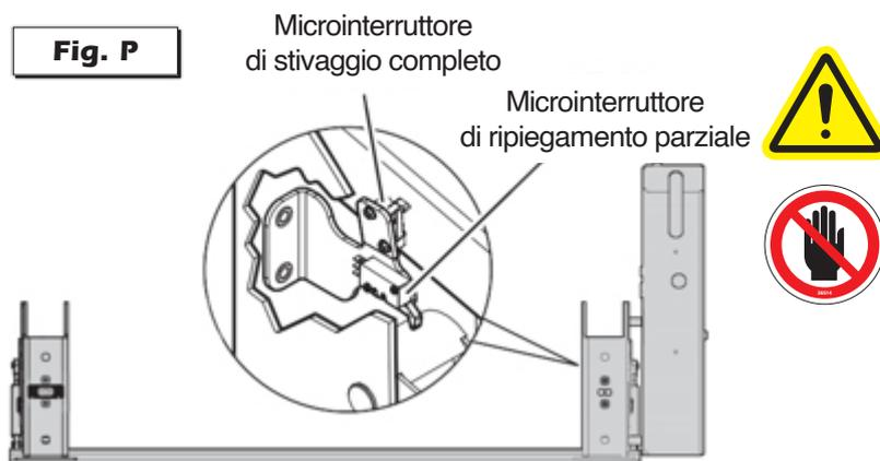
In figura, piattaforma con pompa a sinistra. Per le piattaforme con pompa a destra, i microinterruttori su torretta si trovano sul lato opposto.
