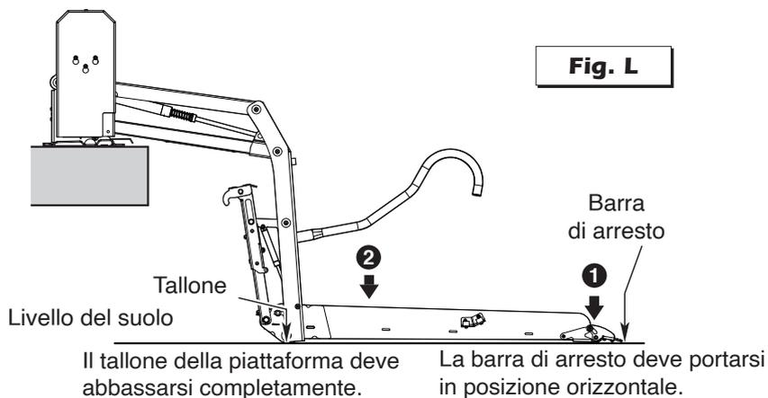
La regolazione dell'angolazione della piattaforma per il corretto contatto con il suolo incide direttamente sull'angolazione della piattaforma a livello del pianale.
