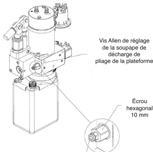
Vis Allen de réglage de la soupape de décharge de pliage de la plateforme
