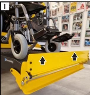
◀ 2. Appuyez sur le bouton ↑ MONTER (photo H) pour replier complètement (verticalement, voir photo I) la butée escamotable et élever la plateforme au niveau du sol. Voir photo J. Interrupteur de déverrouillage. ▶
