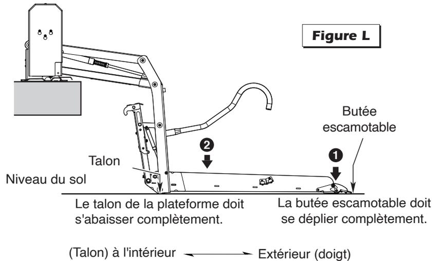
Le réglage de l'angle de la plateforme pour un contact correct avec le sol affecte directement l'angle de la plateforme lorsqu'elle est positionnée au niveau du sol.
