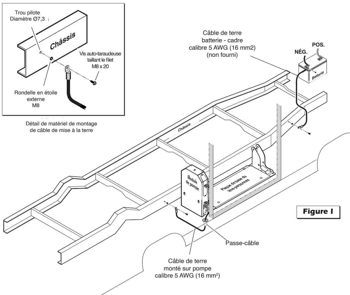
**Corrosion du câble de terre :** Lors du montage des câbles de terre, éliminez la couche intermédiaire, la saleté, la rouille, etc. autour des trous de montage sur la partie du cadre (zone d'un diamètre minimum de 16 mm). Appliquez un revêtement protecteur sur les trous de montage pour éviter la corrosion. Le non-respect de cette consigne entraîne l'annulation de la garantie de certains composants électriques.
