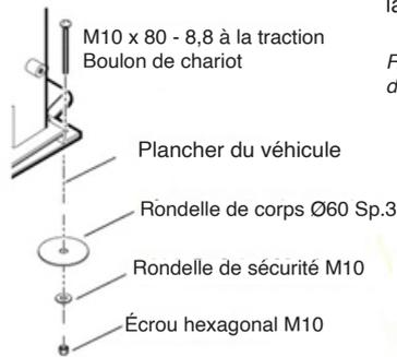
Évitez le montage dans le système d'éléments profilés du véhicule. Si le forage traverse des segments creux, la structure doit être renforcée.
