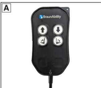
2. Pulse el botón
