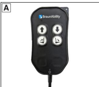
2. Drücken Sie die Taste
