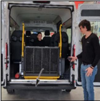
Treten Sie zur Seite und drücken Sie die Taste
