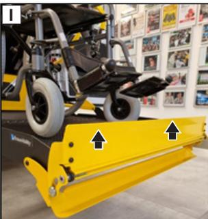
2. Drücken Sie die Taste **↑** ANHEBEN (Foto H), um die Rollsicherung ganz nach oben zu klappen (senkrecht – siehe Foto I) und die Plattform auf Fahrzeugbodenhöhe anzuheben. Siehe Foto J. Geben Sie den Schalter frei.
