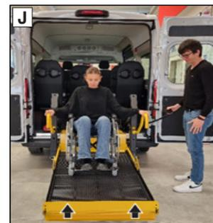
3. Entriegeln Sie die Bremsen des Rollstuhls und geleiten Sie die Fahrgäste von der Plattform.
