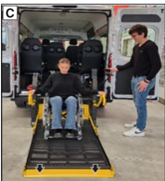
3. Entriegeln Sie die Bremsen des Rollstuhls und geleiten Sie die Fahrgäste von der Plattform.
