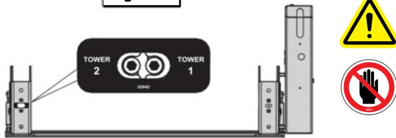
Sur le dessin : la plateforme avec la pompe à gauche. Les emplacements des capteurs de position de la tour se trouvent sur le côté opposé pour les élévateurs à pompe droite.
