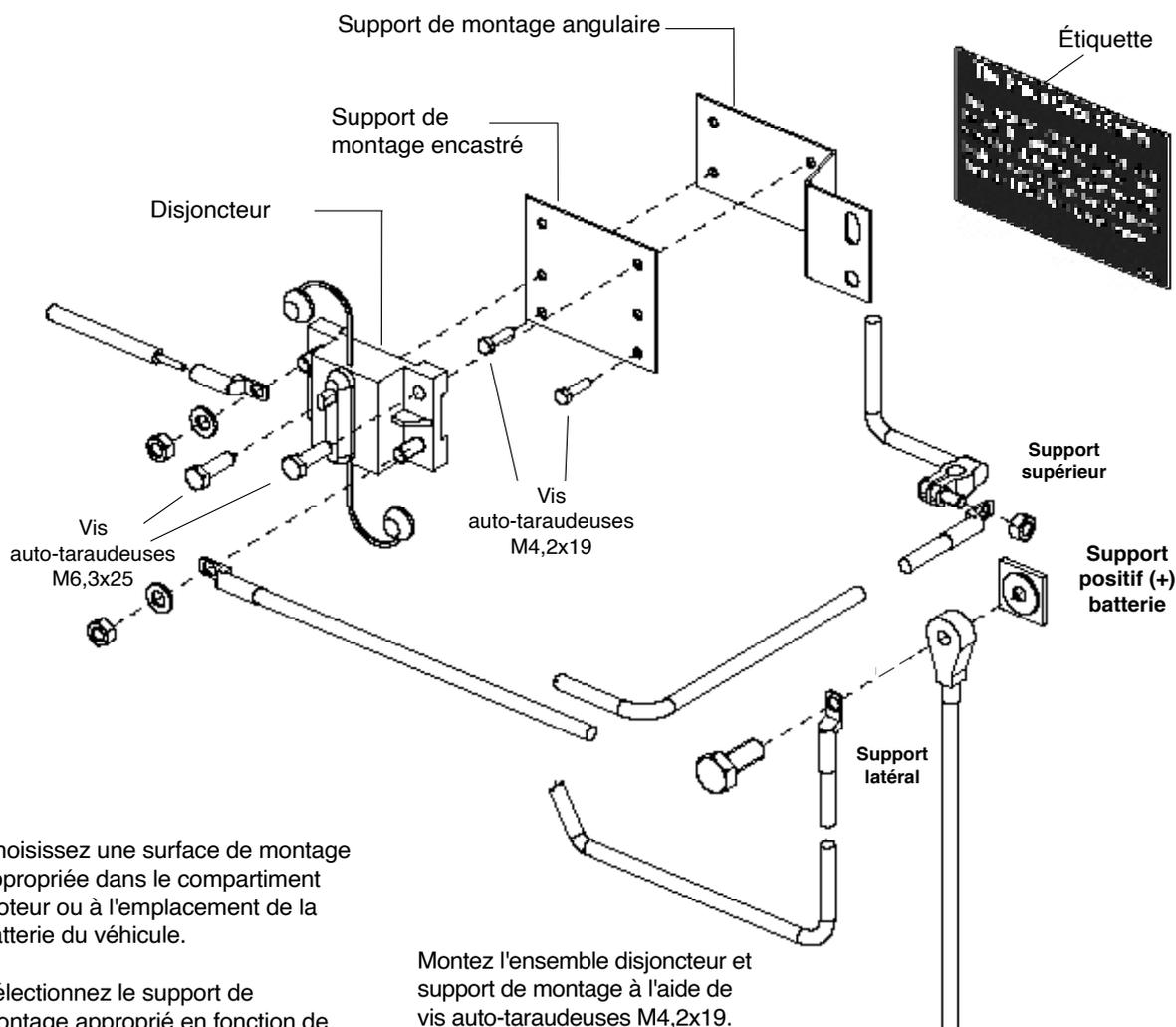
Choisissez une surface de montage appropriée dans le compartiment moteur ou à l'emplacement de la batterie du véhicule.
