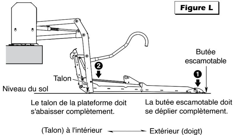
Le réglage de l'angle de la plateforme pour un contact correct avec le sol affecte directement l'angle de la plateforme lorsqu'elle est positionnée au niveau du sol.
