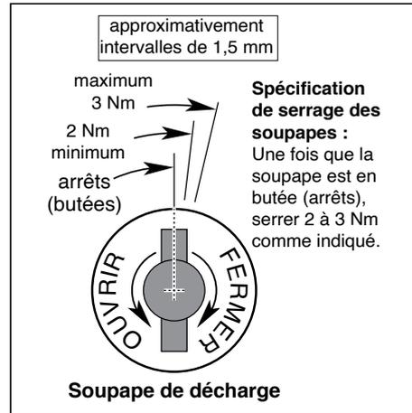
**Avis :** Fermez bien la soupape de décharge de la pompe de secours avant de faire fonctionner la pompe électrique.
