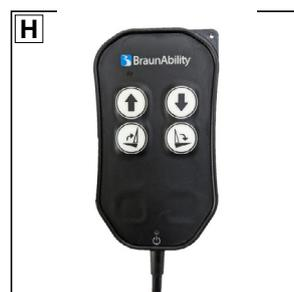
2. Appuyez sur le bouton ↑ MONTER (photo H) pour replier complètement (verticalement, voir photo I) la butée escamotable et élever la plateforme au niveau du sol. Voir photo J. Interrupteur de déverrouillage.
