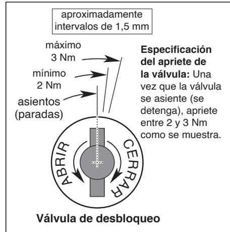
Aviso: cierre bien la válvula de desbloqueo de la bomba de reserva antes de accionar la bomba eléctrica.
