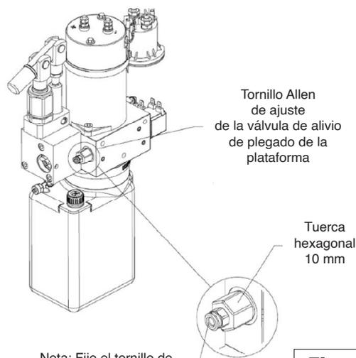
Nota: Fije el tornillo de ajuste y apriete la tuerca hexagonal después del ajuste
