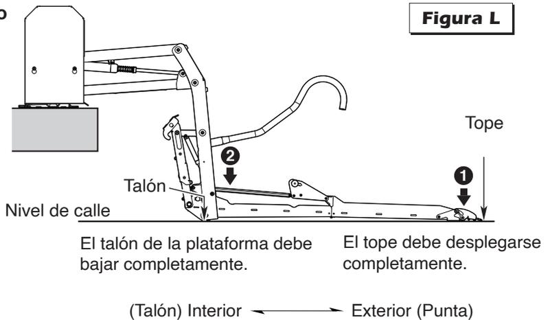
El ajuste del ángulo de la plataforma para un contacto adecuado con el suelo afecta directamente al ángulo de la plataforma cuando se coloca a nivel del suelo del vehículo.
