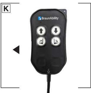
Pulse el botón PLEGAR (hacia dentro) hasta que la plataforma se detenga (completamente plegada). Véanse las Fotos K y L. Suelte el interruptor.
