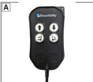
◀ 2. Pulse el botón
