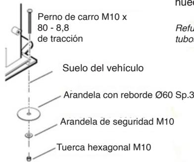
Evite el montaje en el sistema de componentes perfilados del vehículo. Si la perforación atraviesa segmentos huecos, deberá reforzarse la estructura.
