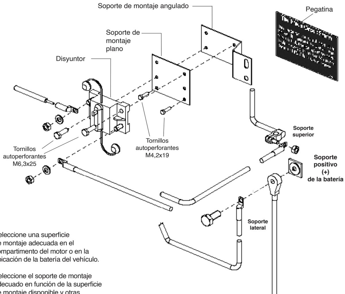
Seleccione una superficie de montaje adecuada en el compartimento del motor o en la ubicación de la batería del vehículo.
