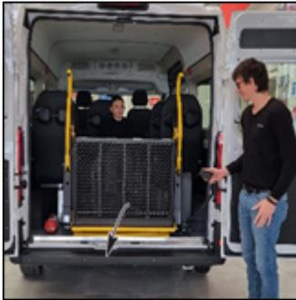
Hinweis: Falls sich die Plattform nicht ausklappen lässt, drücken Sie die Taste
