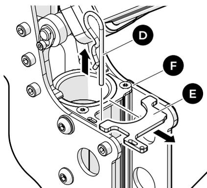
2 Retirez la goupille de verrouillage (D) et la plaque de verrouillage (E) de la grue (F).
