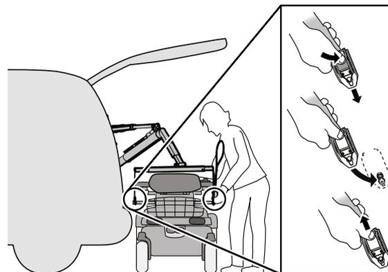
4 Fixez les deux boucles du dispositif de levage aux points de fixation sur l'appareil de mobilité.
