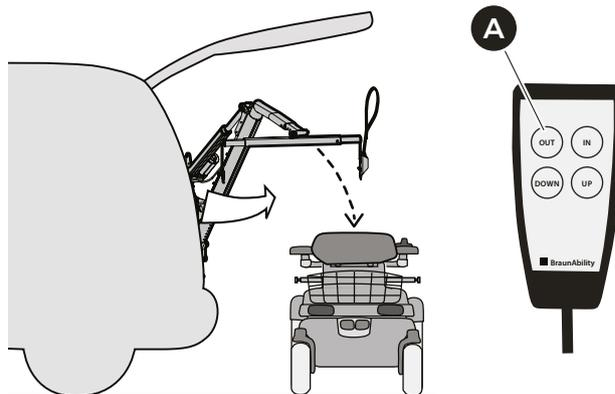
2 Faites pivoter la grue vers l'extérieur en appuyant sur le bouton OUT (A) sur le boîtier de commande portable.
