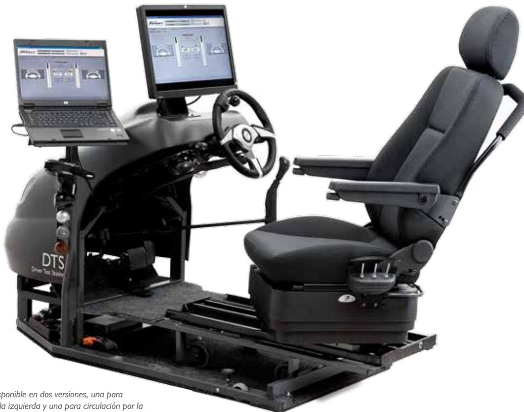
La DTS está disponible en dos versiones, una para circulación por la izquierda y una para circulación por la derecha. Ambas versiones pueden utilizarse con o sin el bastidor de 6 vías.
