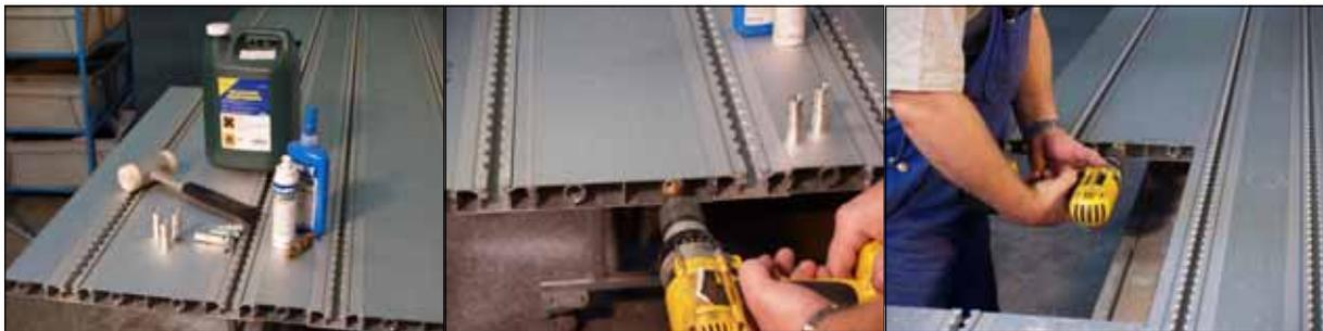
Hier ist zu sehen, was für das Einrichten der Aluminiumrohre (Schlauch-Anschlussstücke) im Boden nötig ist:
