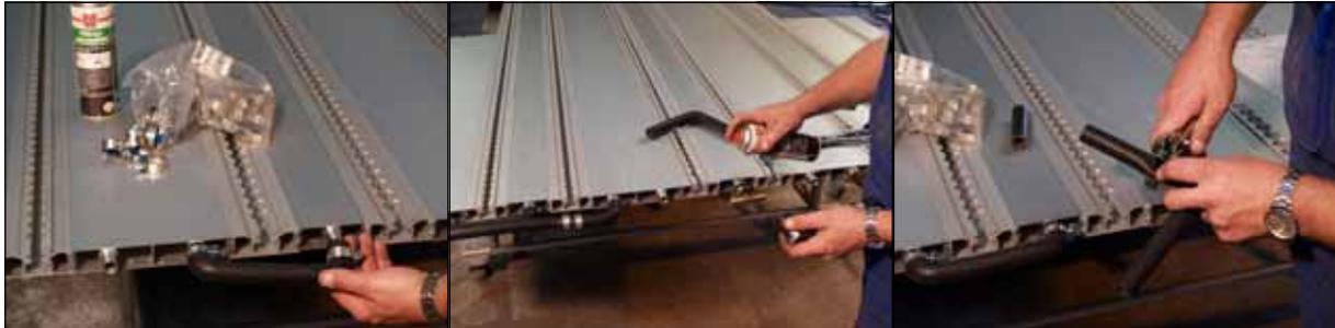
Bei der Montage ist darauf zu achten, dass der passende Schlauch-Clip verwendet wird:
