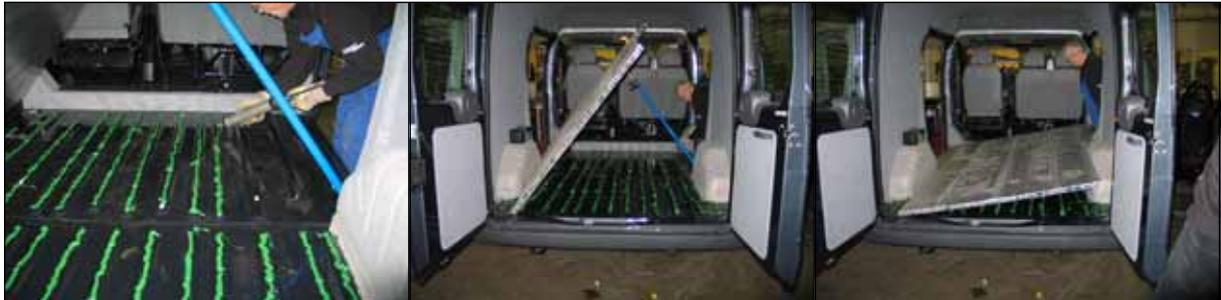
In einem kleineren Van kann der SpaceFloor per Hand eingebaut werden. Beim Einleimen bieten Seitentüren und Heckklappe leichten Zugang.
