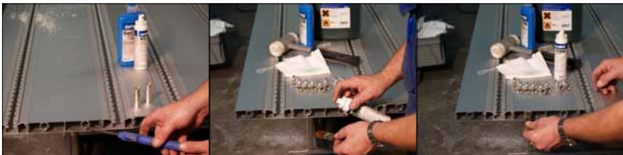
Anschließend werden die Rohre mit Druckluft gereinigt. (Es ist darauf zu achten, dass der gesamte Schmutz und alle Aluminiumteile entfernt werden.)
