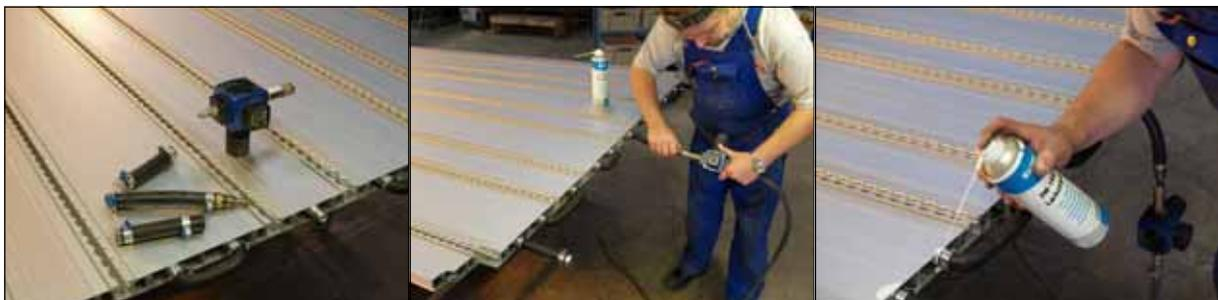
Es werden zwei Schlauchteile gebraucht, die jeweils am Ende mit einem Bolzen abgedichtet sind. Ein weiterer Schlauch wird als Verbindung zwischen dem Boden und einem Druckluftgerät benötigt.
