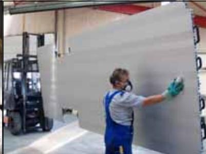
Die Reinigung/Grundierung beginnt dem Boden des SpaceFloor. Es muss immer fusselfreier weißer Stoff, Zellstoff oder Papier verwendet werden.
