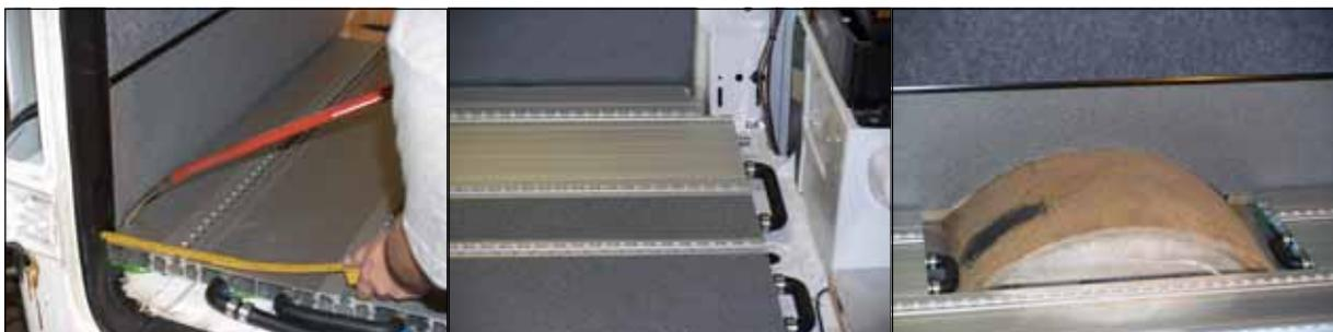
Während der Leim noch feucht ist, wird der SpaceFloor in die richtige Position im Fahrzeug gebracht.
