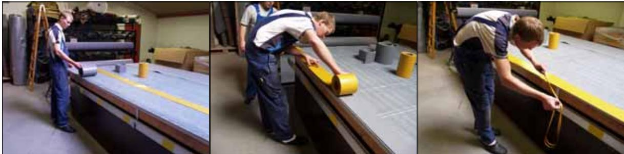
Zunächst werden die Teppichrollen auf die passenden Maße zugeschnitten. Bei Verwendung anderer Teppichbeläge als dem weichen Martech-Teppich muss die Rückseite mit Alkohol gereinigt werden.
