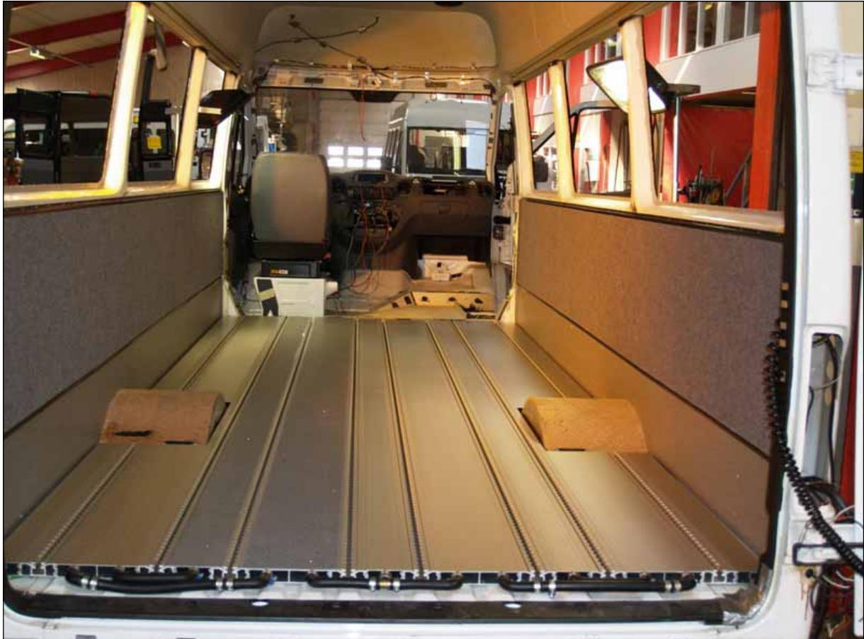
**Der korrekt eingebaute SpaceFloor**
