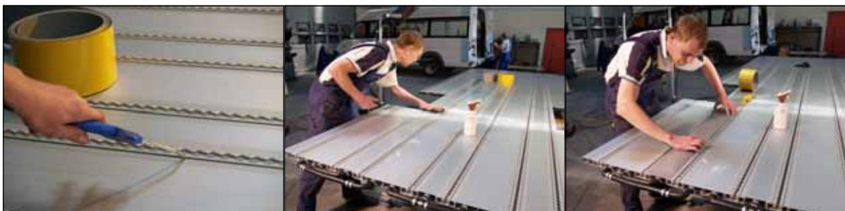
Nachdem alle zum Auslegen erforderlichen Teile vorbereitet sind, wird der SpaceFloor mit einer Druckluftpistole gereinigt, um alle kleinen Aluminiumteile und Rückstände vom Zuschnitt zu entfernen.
