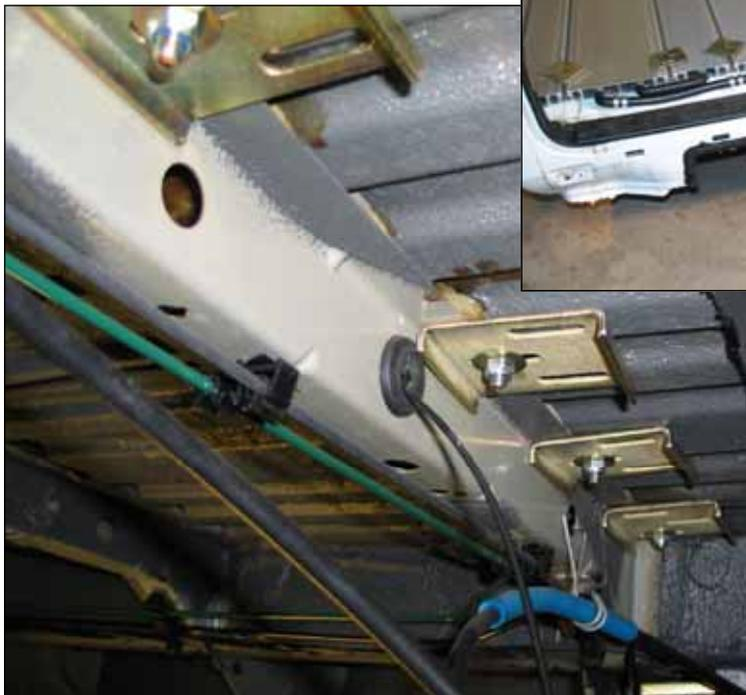
Wenn der Leim noch feucht ist, ist darauf zu achten, dass der SpaceFloor nicht zu stark an die Karosserie angezogen wird! Die Mutter darf nur mit der Plastik-sicherung verwendet werden.
