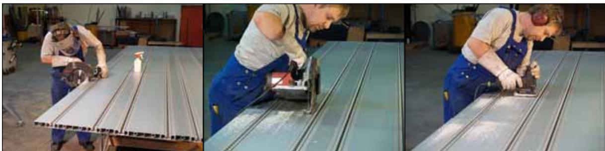
Der Ausschnitt der Teile aus dem SpaceFloor erfolgt mit einer Säge. (Schmiermittel nicht vergessen!)
