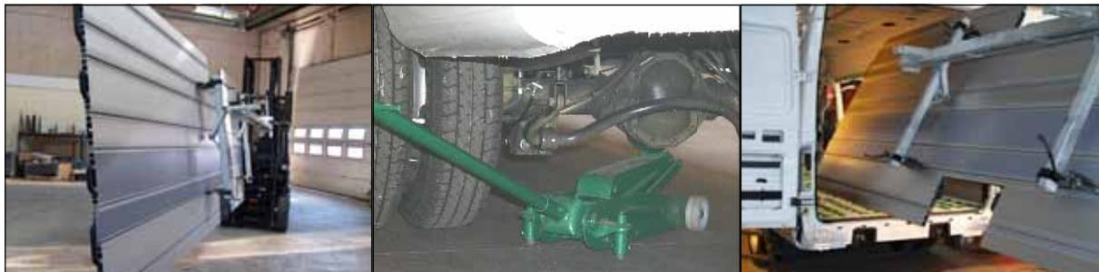
Nell'esempio illustrato ci siamo serviti di un sollevatore a forche per manovrare il pavimento. Naturalmente si tratta solo di un esempio. Chiunque può adottare il metodo più confacente. **È possibile anche ordinare SpaceFloor suddiviso in sezioni in modo da maneggiare più agevolmente il pavimento senza l'ausilio di strumenti particolari.**
