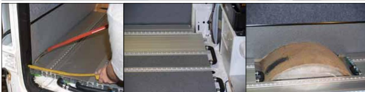
Prima che l'adesivo si secchi, posizionare correttamente SpaceFloor all'interno del veicolo.
