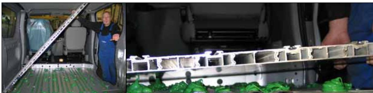
Se la posizione delle guide non corrisponde alle strisce di adesivo, è necessario applicare ulteriori quantitativi di adesivo ogni 40-50 cm sotto la guida.
