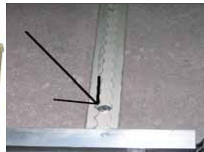
Per ogni guida è necessario un punto di fissaggio di sicurezza. Collocare la staffa di sicurezza più indietro possibile e più vicino possibile a una traversa/pannello posteriore.
