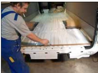
Segnare la posizione delle guide di SpaceFloor sul pavimento della vettura, aiutandosi per esempio con un pezzo di legno. In questo modo si individua con precisione la posizione per l'adesivo.
