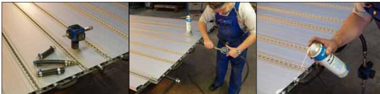
Sono necessari due segmenti di tubo sigillati all'estremità per mezzo di un bullone. È inoltre necessario un tubo da applicare tra il pavimento e il regolatore dell'aria.
