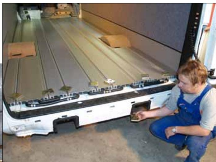
Quando l'adesivo è ancora umido, fare attenzione a non serrare eccessivamente SpaceFloor! Applicare sempre il dado con dispositivo di bloccaggio in plastica.
