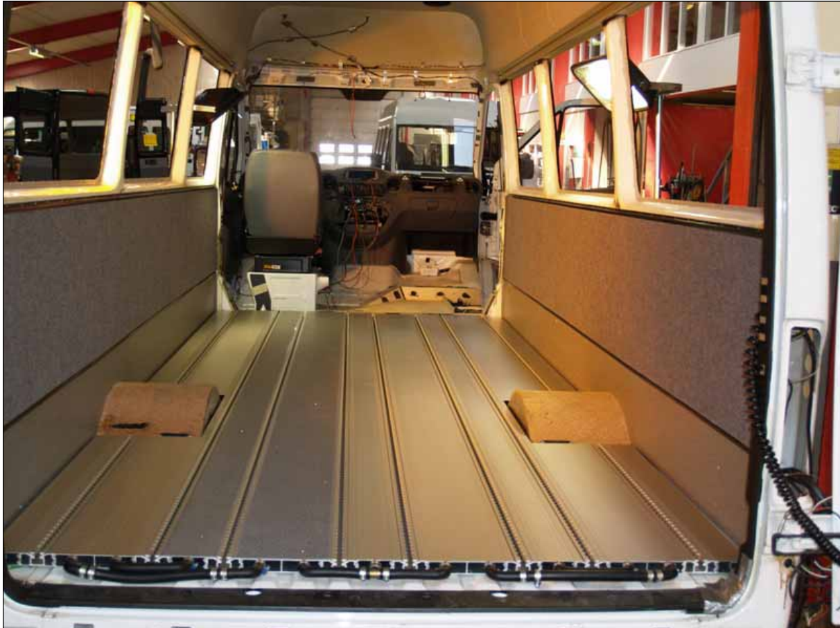
Det korrekt installeret SpaceFloor
