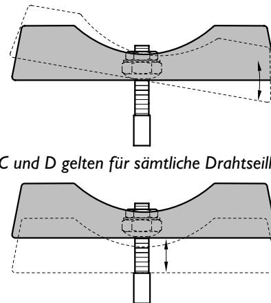
Punkt C und D verleihen der Konstruktion Flexibilität und gewährleisten, dass die Drahtseile gerade bleiben, wenn sie sich bewegen.
