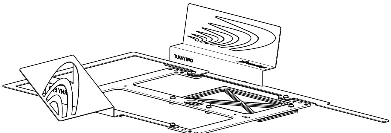
1. Den gråmarkerade delen av mallningsverktyget motsvarar bottenplattan på Turny Evo och kryssramen motsvarar enhetens krocksegment. Kryssramen får inte vila på konsolsidan utan måste placeras vid sidan av för att installationen ska bli plan och stabil.
